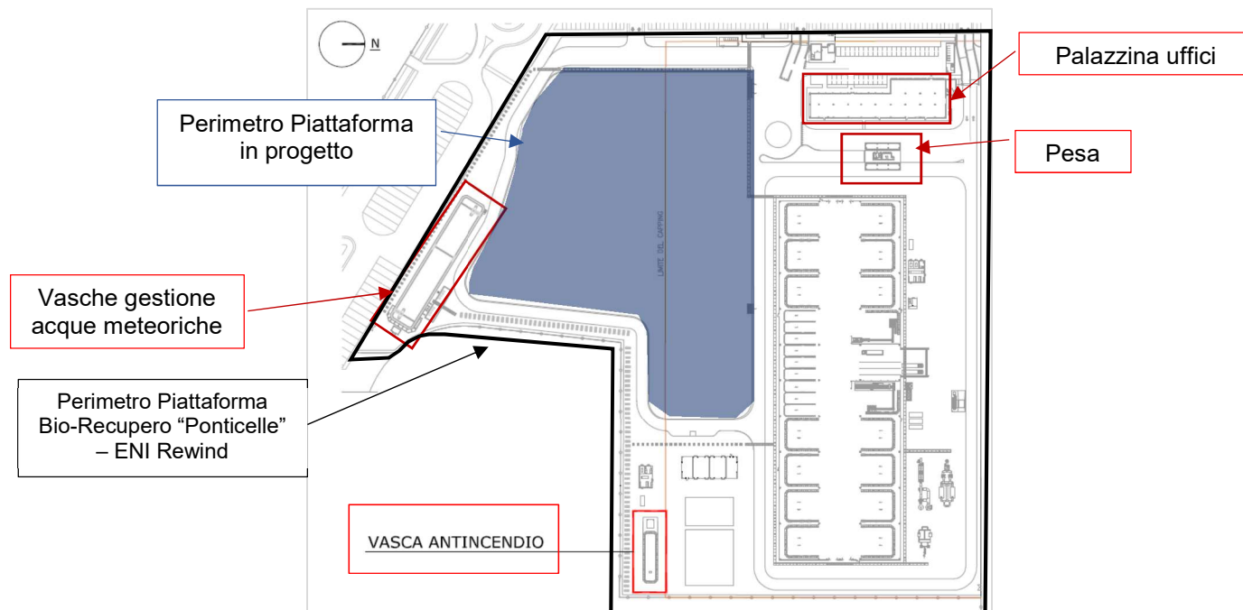
Figura 4 – Stralcio layout generale sito Ponticelle con individuazione del perimetro della piattaforma in esame (in blu), della Piattaforma di bio-recupero ENI Rewind e delle utilities in comune
