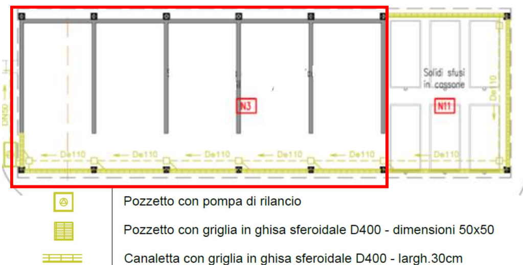
Figura 17 – Dettaglio rete di drenaggio sezione N3 ed N11 (stralcio elaborato CO 05 RA AA 00 DT PL 03.02 – Allegato 3B – Planimetria dell'impianto (rete idrica))
